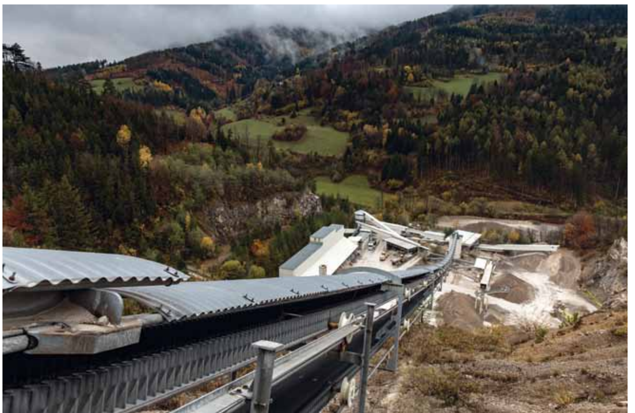
Den Ansatz der Energierückgewinnung verfolgt die Förderbandanlage im Dolomitsteinbruch Ramsau – ihres Zeichens die erste Materialeiseilbahn in Österreich. Fotos: Zeppelin/Sabine Gassner
